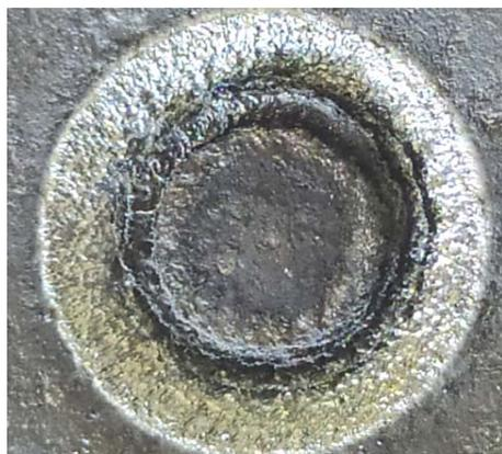
**Рисунок 2.** Прибор ВУП-5 с мишенью (верхний рисунок) и изображение поверхности мишени после напыления (нижний рисунок).
