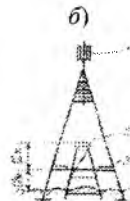
1 — визулаш цилиндри; 2 — теодолитнинг ўрнатиш столчаси; 3 — кузатувчининг турар ўрни.
