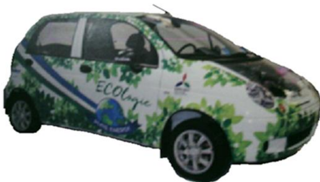
VII.2.3-Rasm.Matiz avtomobili asosida yaratilgan, vodorodda harakatlanuvchi avtomobilning sinov modeli.
