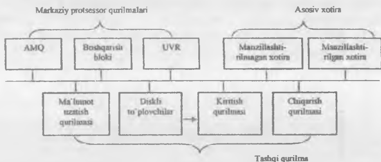
2.1-rasm. Kompyuterning funksional sxemasi
