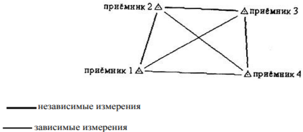
Рис.2. Схема, иллюстрирующая проект независимого определения 3-х линий из сеанса, выполняемого на 4-х пунктах
