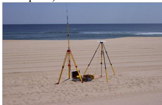
1.18-расм. GPS услубида жойда нуқтанинг планли координаталарини аниқлаш усули; GPS асбоблари.
