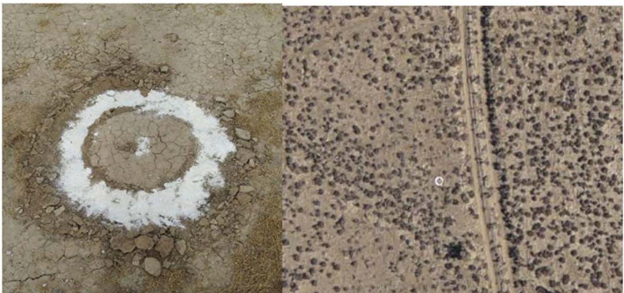
Рисунок Г.3 Маркировка опознаков, фотоабрис на левом снимке, на правом аэроснимок
