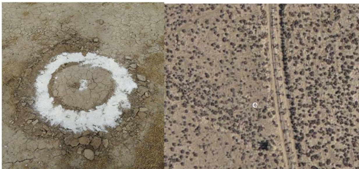
Г.3 – расм. Опознакларни маркировка қилиш, чап суратда фотоабрис, ўнгда аэросурат
