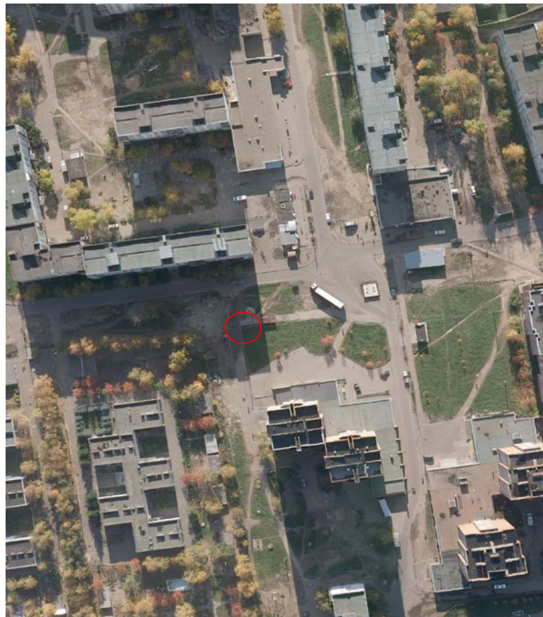
Рисунок Г.1 Обозначение пункта съемочной сети/опознака на аэрофотоснимке
