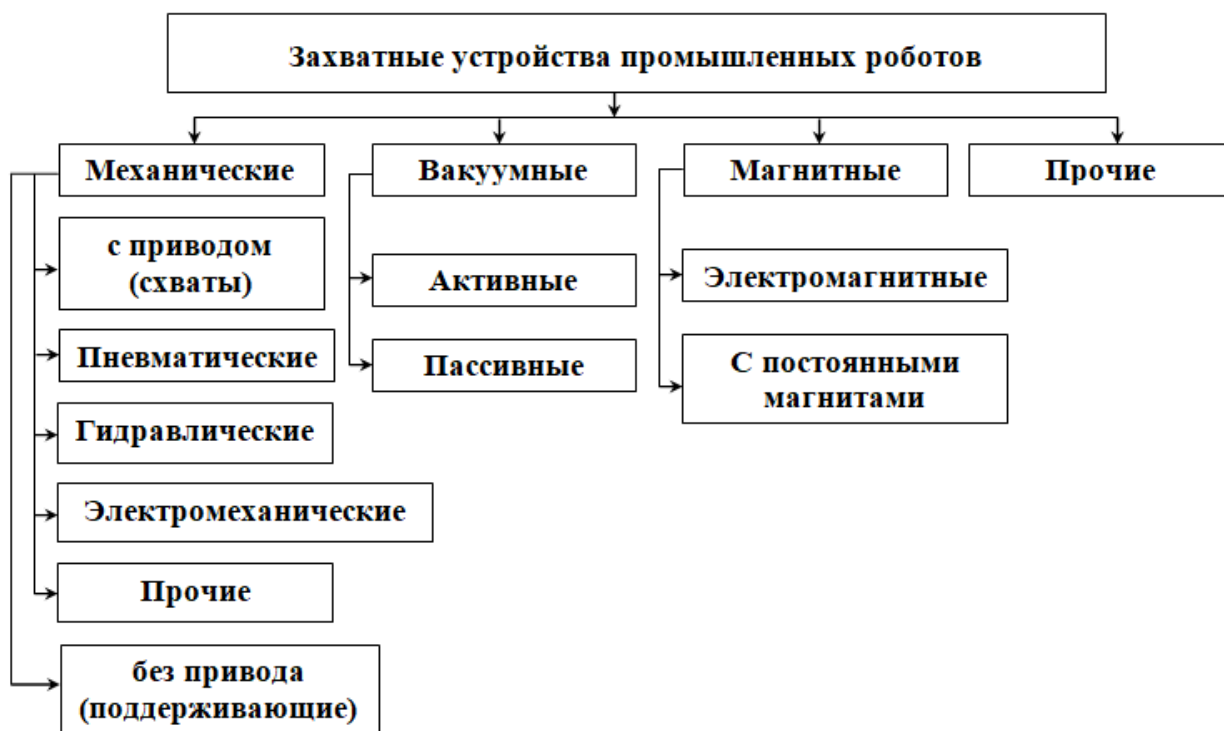
Рис. 3.1. Типы захватных устройств, промышленных роботов.
