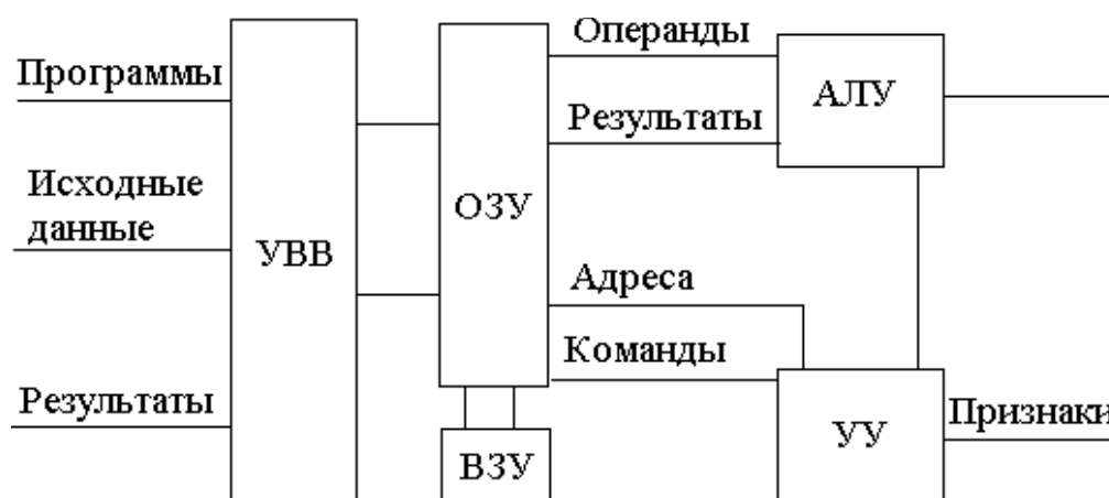
Рис. 5. Архитектура ЭВМ, построенной по принципам фон Неймана.
