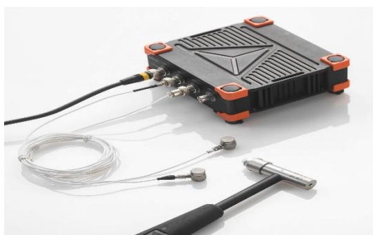
5.46-rasm. Ikki akselerometr va modal bolg'a ga ulangan Dewesoft ma'lumotlarni yig'ish tizimi
