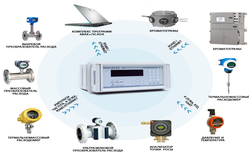
5.11- rasm. "ABAK+" (IVK ABAK+) asosida gazni o'lchash tizimlarini qurish variantlari
