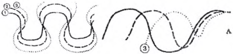
Рис. 12. Переформирование излучин: А – сжатие и «стачивание» колена меандры; Б – образование омегавидных меандр и «перезимы» их шеек вследствие размыва вогнутых берегов; 1, 2, 3 – последовательные положения русла быстро мелеет в результате аккумуляции наносов, остальная сохраняется ряд лет сначала в виде затона (изолированного от межсезонного течения только в верхней части), а затем в виде старицы – пойменного озера.
