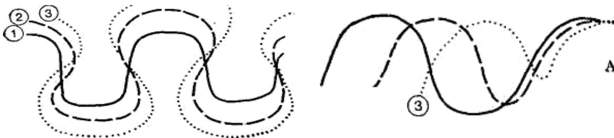
*Рис. 4.7. Переформирование излучин: А - сжатие и «стачивание» колена меандры; Б - образование омегавидных меандр и «перезжимы» их шеек вследствие размыва вогнутых берегов; 1, 2, 3 - последовательные положения русла быстро мелеет в результате аккумуляции наносов, остальная сохраняется ряд лет сначала в виде затона (изолированного от меженного течения только в верхней части), а затем в виде старицы - пойменного озера*
