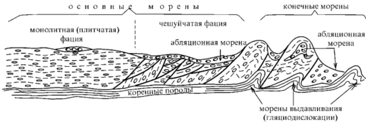
*Рис. 5.5. Принципиальная схема строения моренного комплекса
