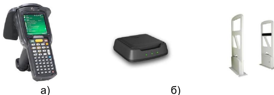
Рис. 3.7. Считыватели (ридеры) RFID-меток (изображения не в масштабе): а) портативный (ручной); б) настольный (RFID-планшет); в) стационарный (RFID-ворота)
