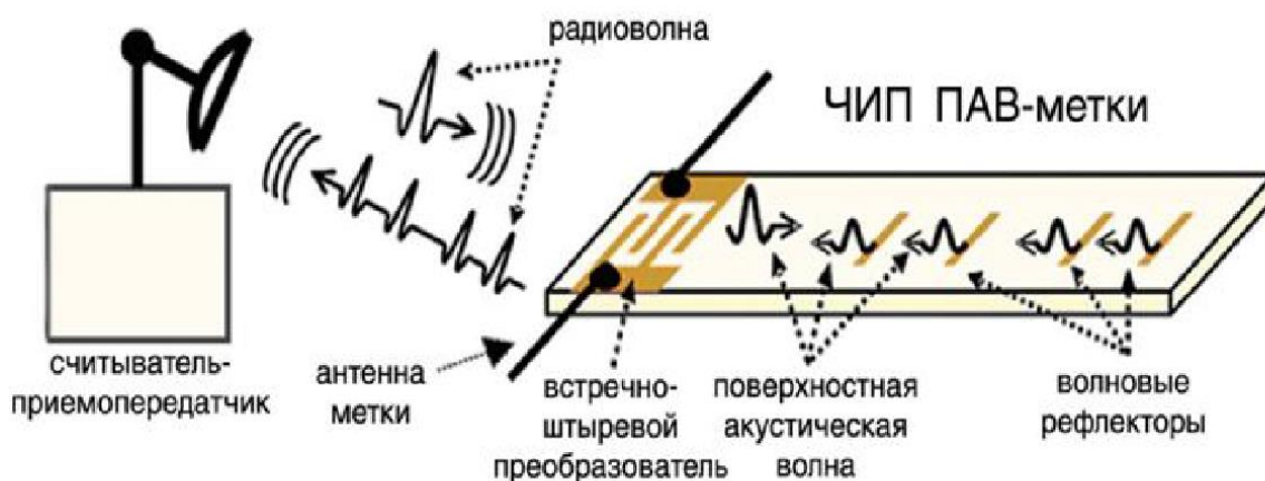
Рис. 3.5. Конструкция SAW-метки
