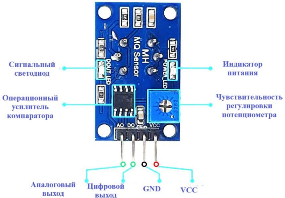
Рисунок 9.2. Устройство газового сенсора MQ-5.
