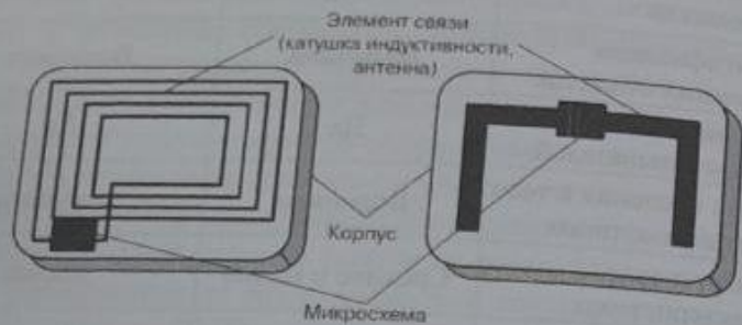
Рис. 14.3. Принципиальная схема RFID метки: слева - метка с индуктивной связью, справа - микроволновая метка с антенной-диполем
