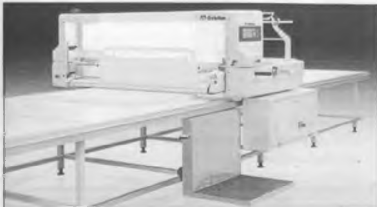
10-rasm. Ozbilim P2 ADD avtomatik to'shash mashinasi
