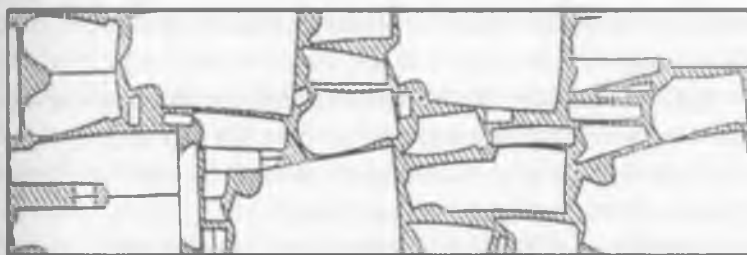
7-rasm. Eraklar paltosi detallarining andozalarini gazlama ustiga joylashtirish
