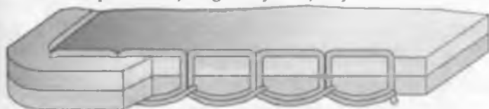
15-rasm. Bir ipli zanjirsimon baxyaqator
