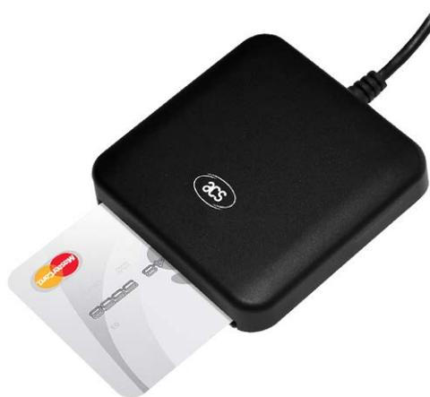
**Рис.4.1. Смарт-карта и устройство считывания смарт-карт (ACR39U)**
