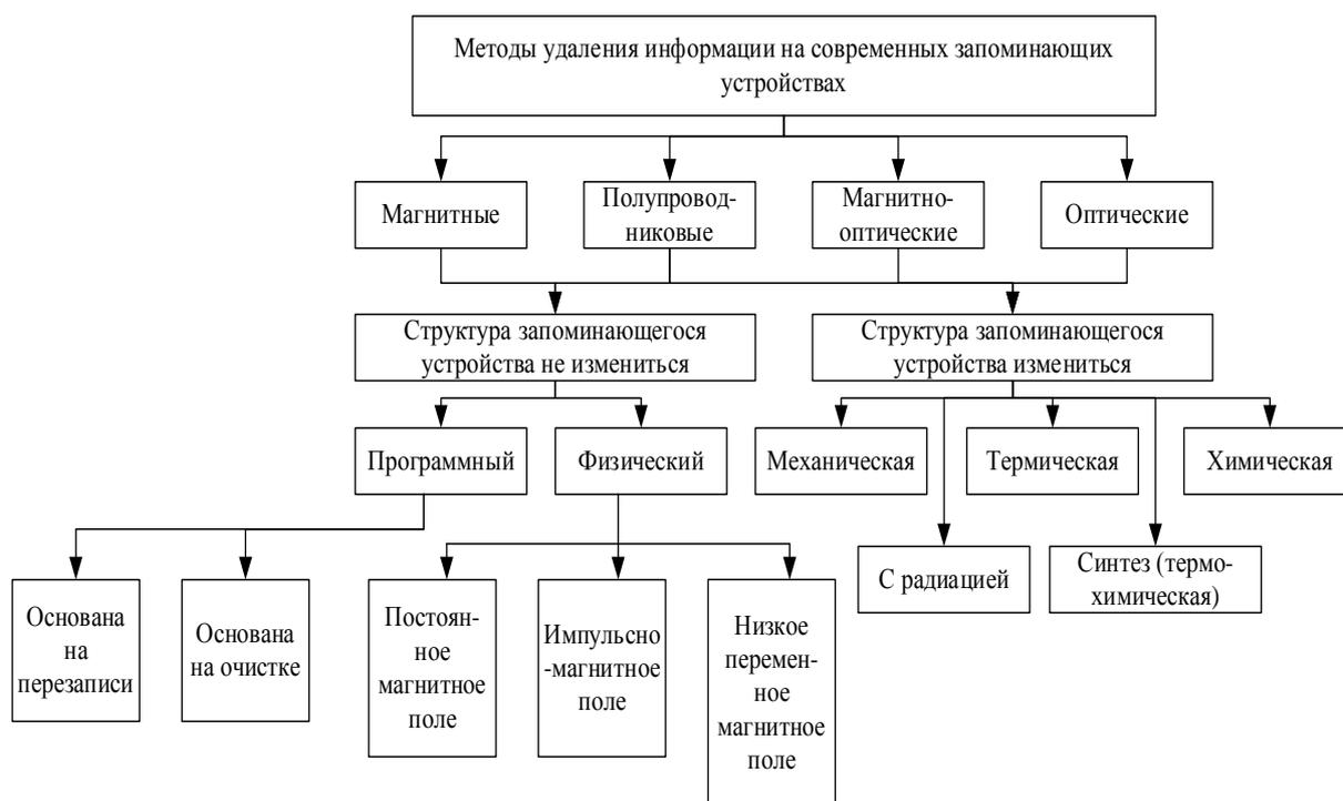
**Рис.3.17. Методы уничтожения данных из электронных запоминающих устройств**
