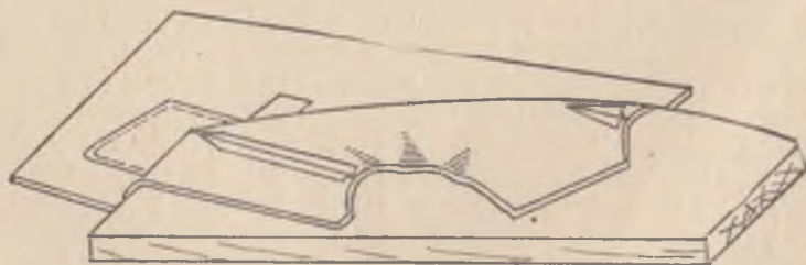
173- расм. Олд булакка дазмолда намлаб-иситиб ишлов бериш.
