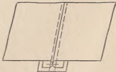
246-расм. Қават газлама кийимнинг ён ва елка чокларига тасма қўйиб тикиш.
