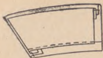
269- расм. Кўйлакнинг ағдарма чокли ёқасини тикиш.
