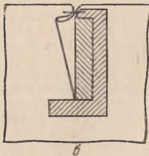
120- расм. Қирқма (а) ва яхлит (б) витачкаларни қўшимча газлама қўйиб тикиш.
