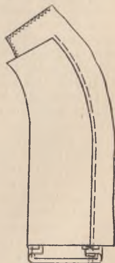
215-расм. Тугма жойни шимнинг ўнг олд бўлагига улаш.
