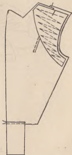
164-расм. Борт қотирмасини елка таглик қўйиб, қил қатламсиз тикиш.
