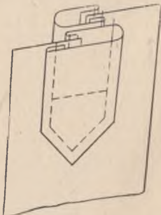
263-расм. Қўйлакнинг бостирма қопқоқли тақилмасини тикиш.
