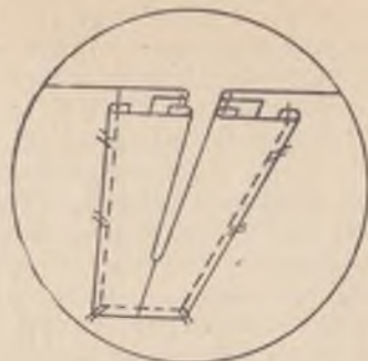
265- расм. Қўйлакнинг икки мағизли тақилмасини тикиш.
