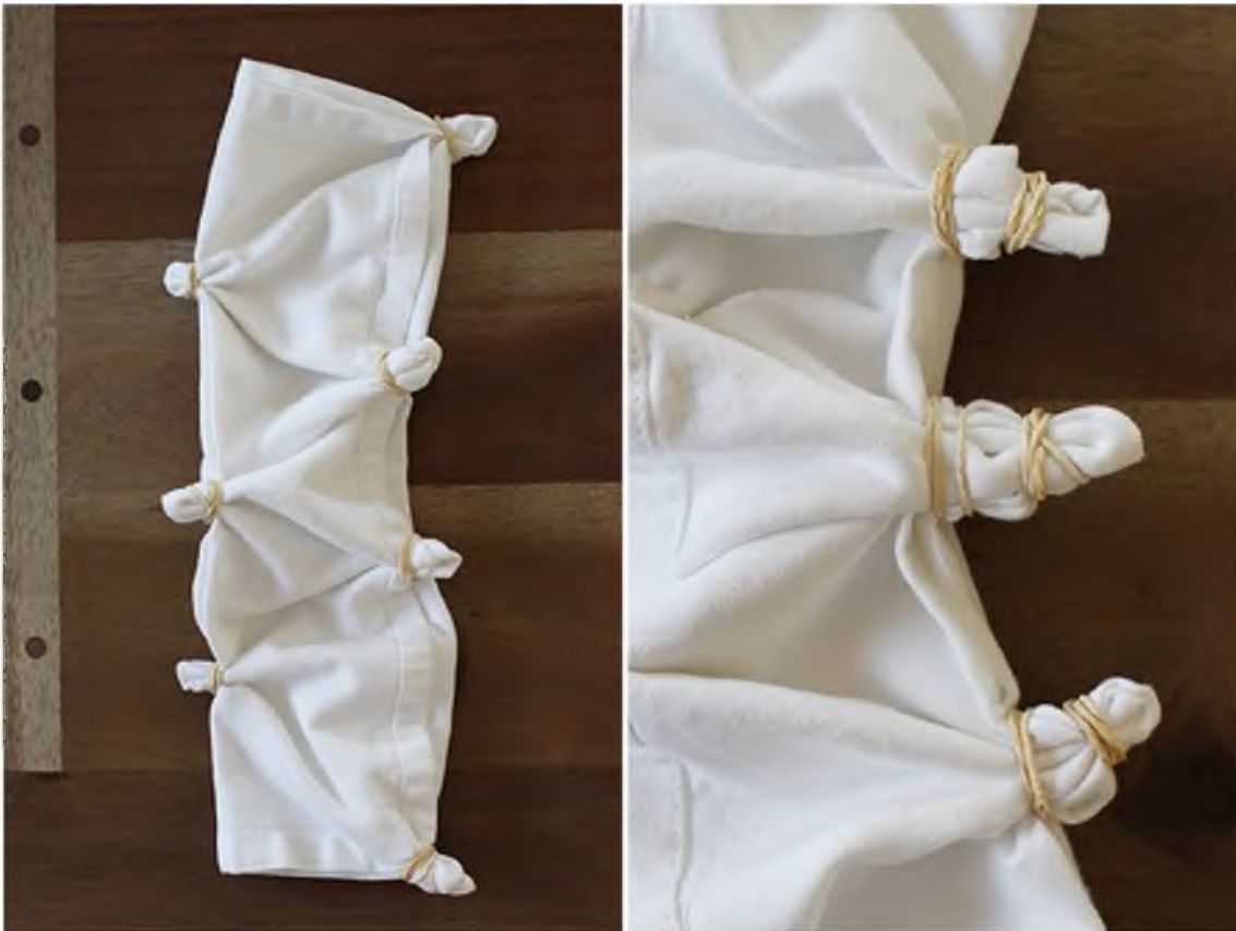
2.25-rasm. Tugunli bo'yash texnologiyasida tugunlarni o'rashga misollar.
