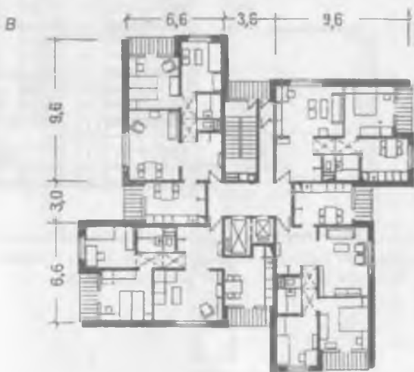
33-rasm. «Shamol tegirmoni» shaklidagi uylarning tarxlari: A – Berlin shahridagi 25 qavatli uyning andozali qavatli tarxi; B – Moskva shahri uchun 16 qavatli uy loyihasi.
