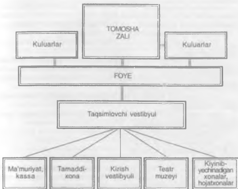
130-rasm. Tomoshabin zalining texnologik jihatdan bog'liqlik sxemasi.
