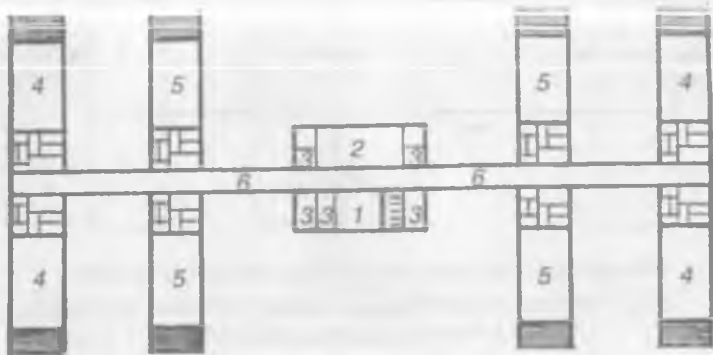
58-rasm. 280 o'rinli bolalar muassasasining asosiy xonalar guruhining o'zaro bog'liqlik sxemasi:
