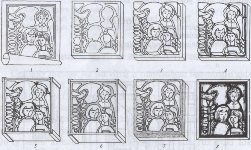
26-rasm. Betonli vitraj tayyorlash tartibi. 1 — qog'ozdagi eskiz; 2 — vitraj asosiy chiziqlarini planshetga chizish; 3 — shisha bloklarini yotqizish; 4 — metall armaturalarni joylash; 5 — planshet atrofini devorchalar bilan o'rab olish; 6 — beton qorishmasini quyish; 7 — devorchalarni olib tashlash; 8 — tayyor vitraj.
