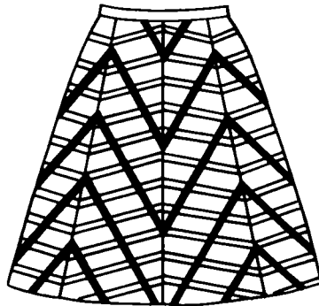
60- расм. Юбка бўлакларига катакларни симметрик жойлаштириш: а — диагональ; б — арчасимон
