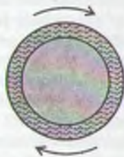
28.2-rasm. Ikkita konsentrik silind yordamida suyuqlik yopishqoqligini o'lchash.
