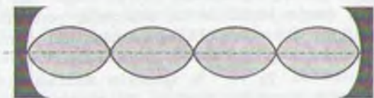
22.7-rasm. Rezonatorda turg'un to'lqin.
