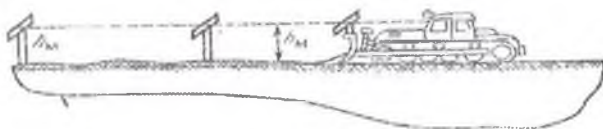
13.39-rasm. Qurilish mashinalarini andozalar bilan boshqarish
