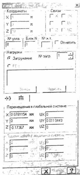
5.77-rasm. Deformatsiyalangan sxemaning tuguni haqidagi ma'lumotlar.
