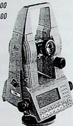
11.9.–rasm. Klassik elektron teodolitlari, LEIKA T 1100, T 1800.
