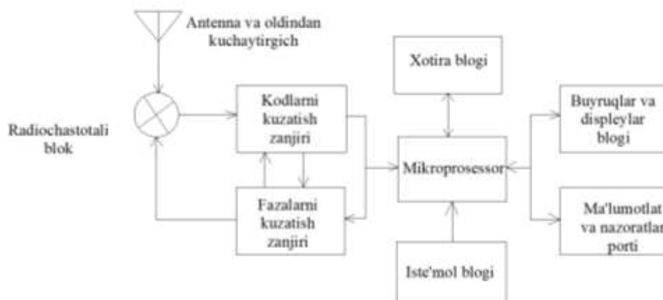
13.1-rasm. Bir kanalli GPS priyomniklar uchun, umumiy, asosiy komponentlar
