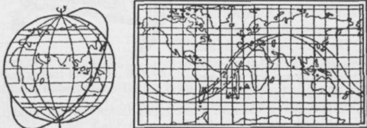
62-rasm. Kosmik apparatlarning uchish yo'li (trassasi) sxemasi.
