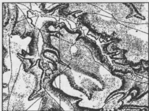
55-rasm. Relyefning shtrix chiziqlar bilan va tasvirlanishi.
