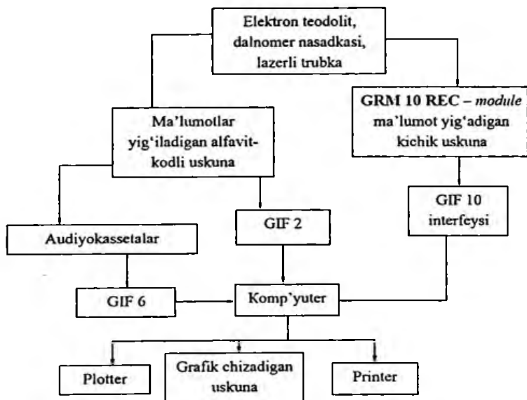
11.11-rasm. Lazerli elektron geodezik asboblarning ishlash tamoyili
