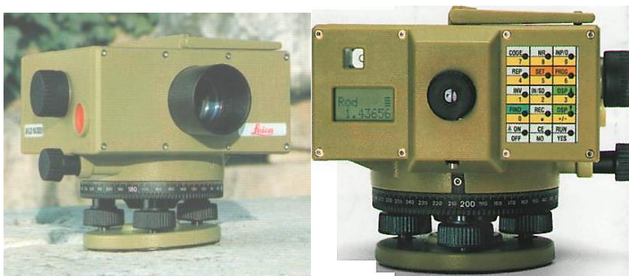
2.18–rasm. Elektron nivelir NA 2000 da "Wild" (Shveysariya)
