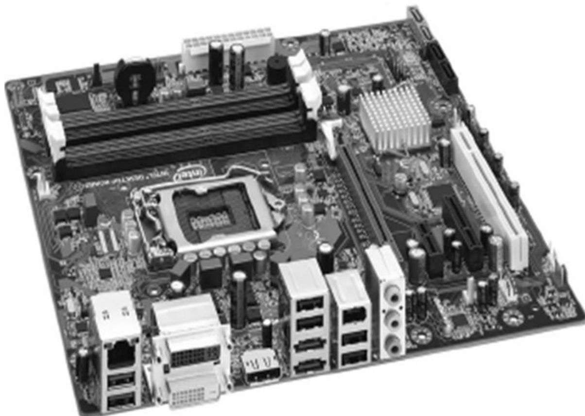
1.9-rasm. Shaxsiy kompyuterning asosiy bosma platasi.
