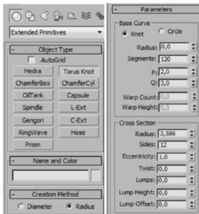
3.2.6-rasm. Toriodal tugunidagi asosiy parametrlar.
