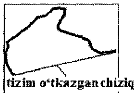
36-rasm. Oxirigacha chizilmagan maydon chegarasini tizim avtomatik yo'l bilan bosh va oxirgi nuqtalarni birlashtiruvchi chiziqni o'tkazadi
