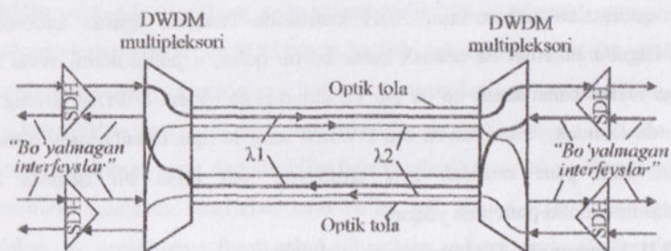
10.4-chizma. Bitta tolada turli uzunlikdagi to‘lqinlarni multiplesirlash tamoili.
