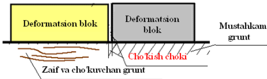
3.3-rasm. Sanoat binosi alohida bloklari har xil jinsli gruntlardan iborat asos ostida bo`lgan cho`kish chokining joylashish sxemasi
